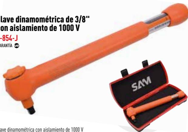
Llave dinamométrica con aislamiento de 1000 V con trinquete fijo. Se utiliza para las operaciones de aprietes controlados en zonas con tensión, armarios eléctricos o máquinas en funcionamiento. Ajuste rápido del par de apriete mediante la rueda dentada en el extremo de la llave. La llave se suministra en una caja con su certificado de conformidad. Precisión: +/- 4%.
